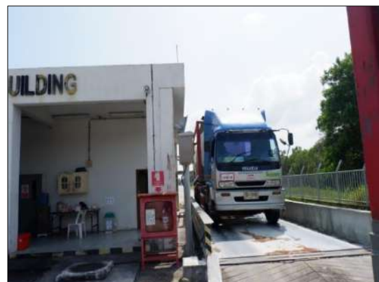
รูปที่ 2-40 ที่ชั่งน้ำหนักรถบรรทุก NGL โดยกำหนดไว้ไม่เกิน 15 ตัน/คัน
